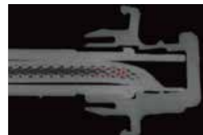
インサート成形後の内部可視化
